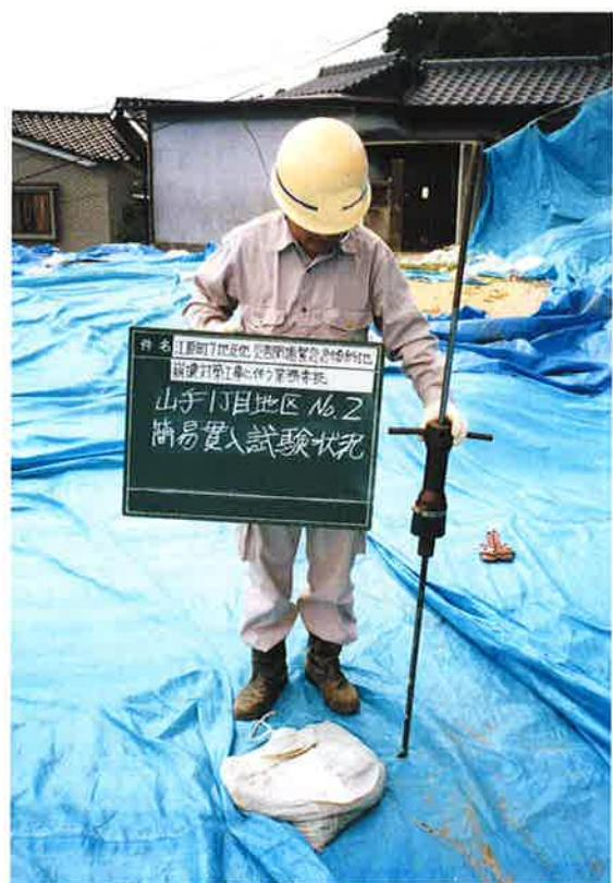
【写真4-4】 簡易動的コーン貫入試験状況
