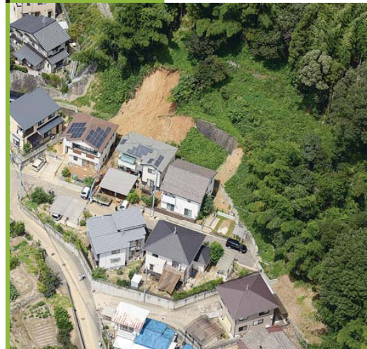
斜面崩壊状況
