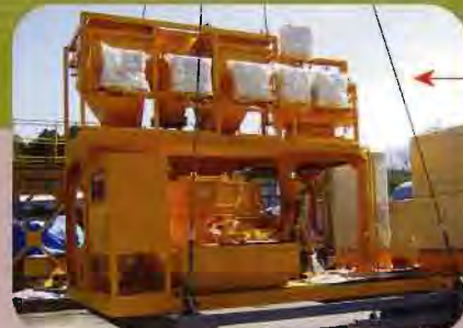
空輸されるコンクリートプラント
