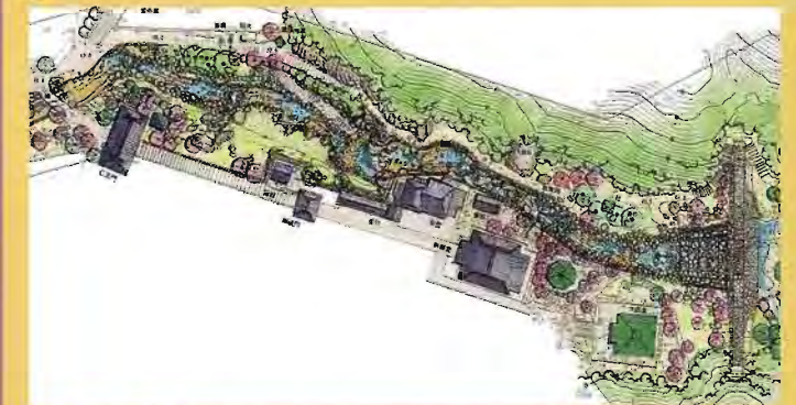
2号堰堤と溪流保全工(L=187.4m)の完成イメージ
